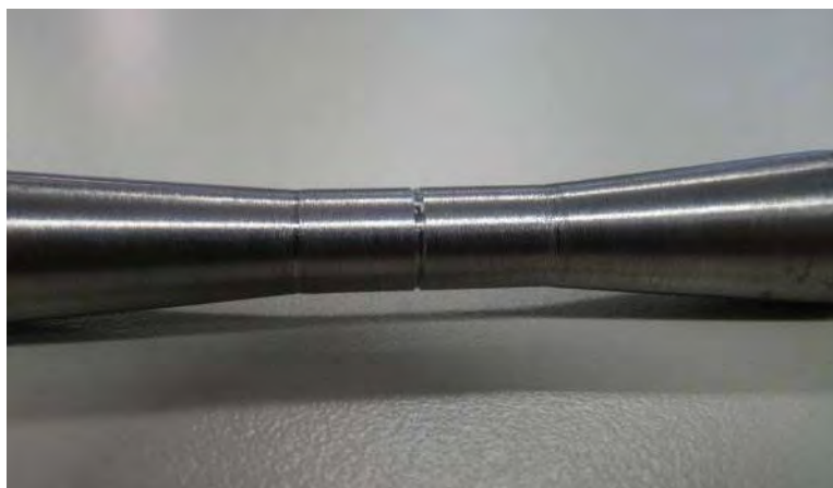
Figura 6. Detalhe do entalhe do corpo de prova “S”.
