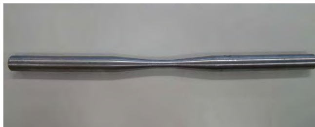
Figura 4. Corpo de Prova “A” Usinado Conforme as Normas.
