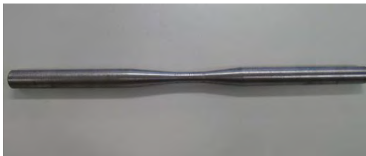
Figura 5. Corpo de prova “S” usinado conforme as normas, com entalhe.
