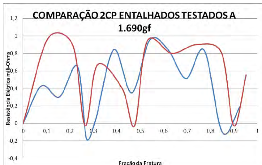
Figura 13. Comparação entre dois corpos de prova S testados com a mesma carga de 1690g.
