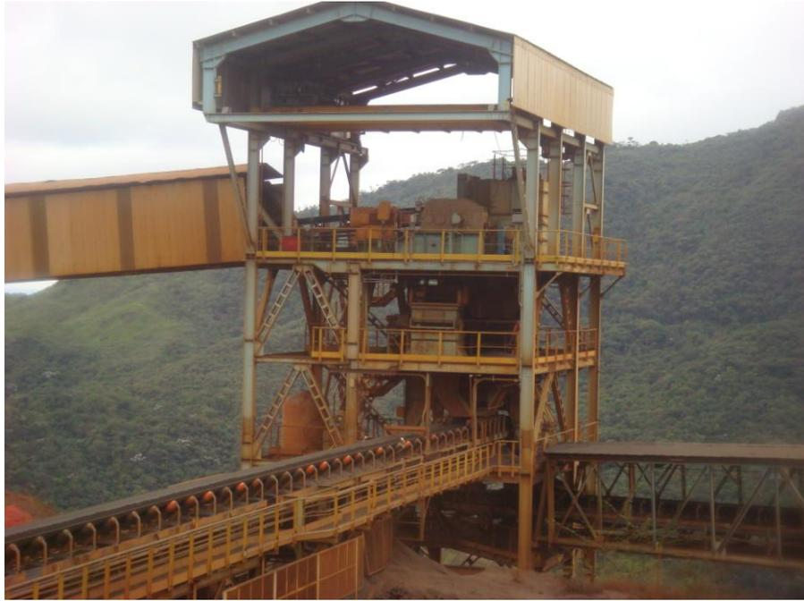
**Figura 4: Torre de amostragem do ROM britado da mina de Fábrica Nova.**
