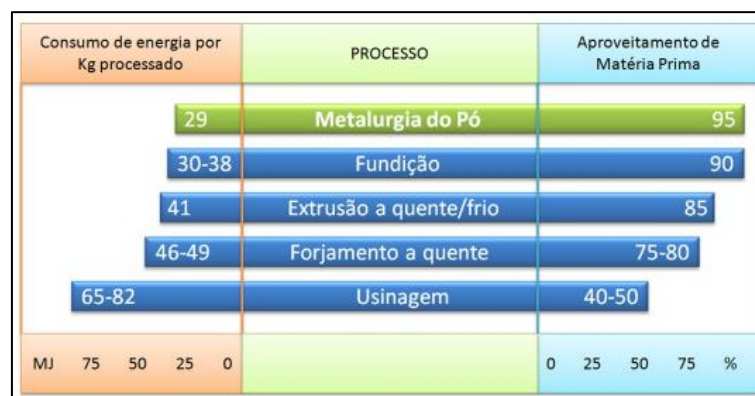
Figura 2. Comparação de consumo de Energia e uso de Matéria-Prima de processos de manufatura [2].
