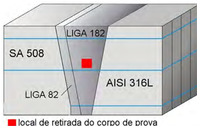
Figura 1. Representação esquemática da região onde foram retiradas amostras para caracterização estrutural do filme de óxido.
