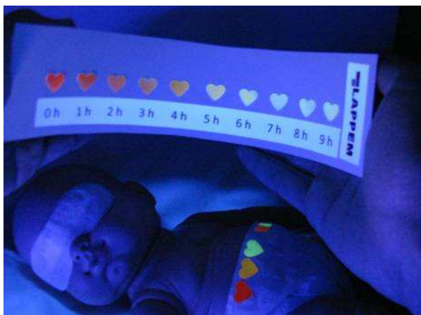
Figura 4: Filmes auto-colantes de PS/MEH-PPV/Alq 3 submetidos a diferentes tempos de exposição a radiação (de 0 a 9 horas).
