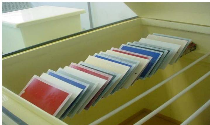
Foto 2 – Foto exemplo da disposição das amostras Câmara de Névoa Salina (Salt Spray)
