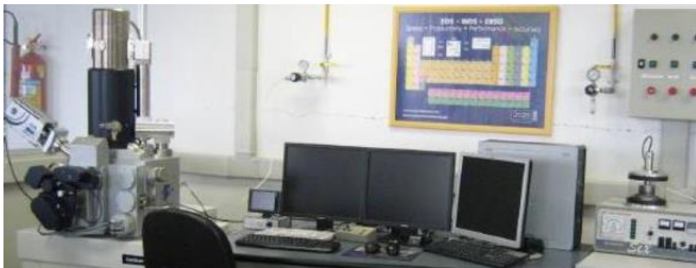
Figura 7. Microscópio eletrônico de varredura (MEV). Laboratório de Materiais, FEI.
