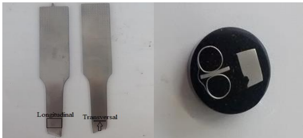
Figura 6. Corpos de prova fraturados e cortes longitudinal e transversal embutidos em baquelite.
