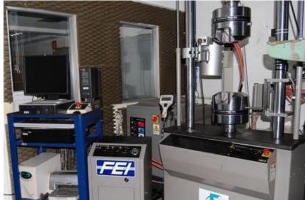
Figura 5. Máquina universal de ensaios MTS810, capacidade 25 kN. Laboratório de Materiais, FEI.
