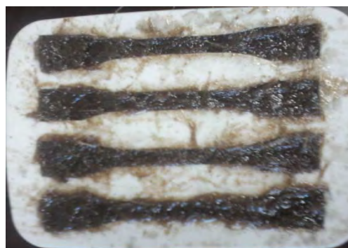
Figura 5. Compósito vazado no molde de silicone.
