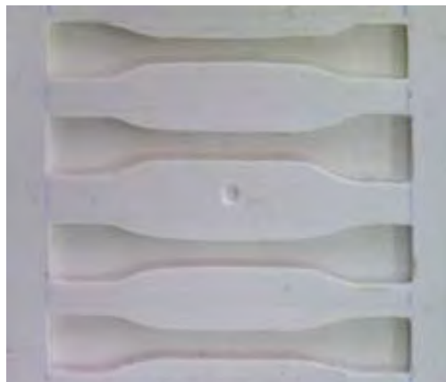
Figura 3. Moldes de silicone utilizados para caracterização e confecção dos corpos de prova.
