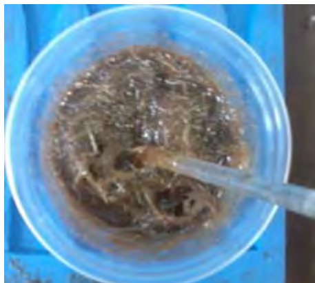
Figura 4. Homogeneização fibra/ resíduos de madeira/ resina.
