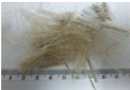
Figura 1. Fibras de malva cortadas nos comprimentos utilizados, a exemplo do corte de 20 mm.
