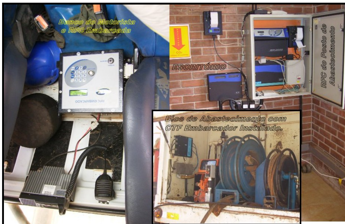
Figura 3: CTF Embarcado Instalado em um Caminhão Comboio
