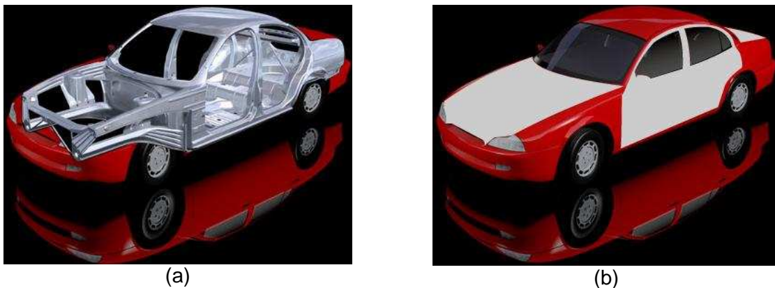
Figura 1 – Projeto da carroceria de um automóvel moderno. Em (a), a estrutura é mostrada e, em (b), os fechamentos podem ser observados. (2)
