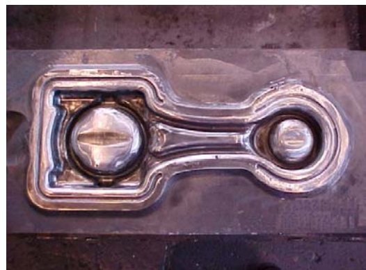
Figura 7. Matriz para forjamento a quente de biela, analisada no caso 2, em que o aço VHSUPER foi testado.
