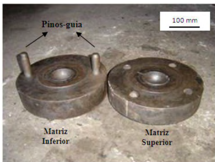
Figura 4. Matriz superior e inferior empregadas no forjamento dos corpos moedores.
