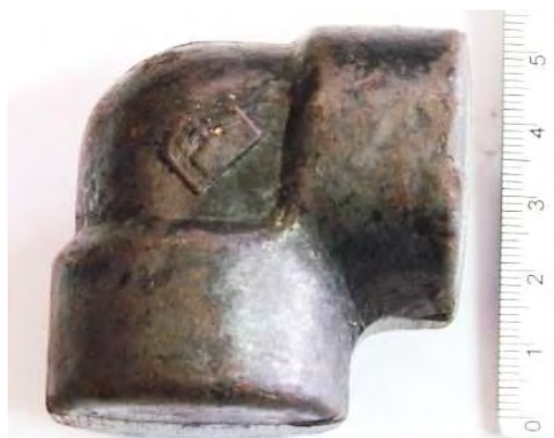
Figura 1. Conexão semi-acabada forjada a quente.
