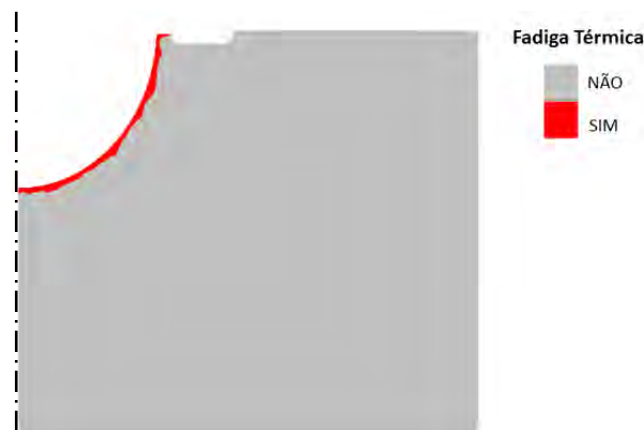
Figura 10. Mapeamento das áreas sujeitas à fadiga térmica obtida pela subrotina.
