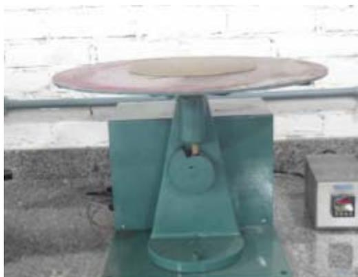
Figura 1. Mesa de determinação do índice de consistência.
