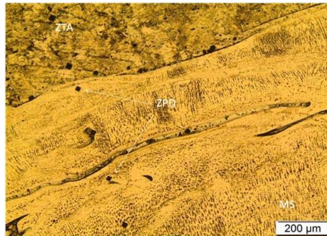
Figura 8. Micrografia apresentando o metal de solda, zona parcialmente diluída (ZPD) e a ZTA do revestimento SAW – 9. Ampliação: 100x.
