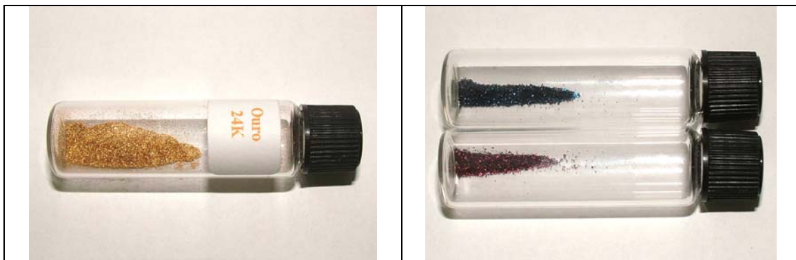
Figura 4. Macrografias dos pós de ouro puro (24k), à esquerda, e ouro azul e rubi, à direita.
