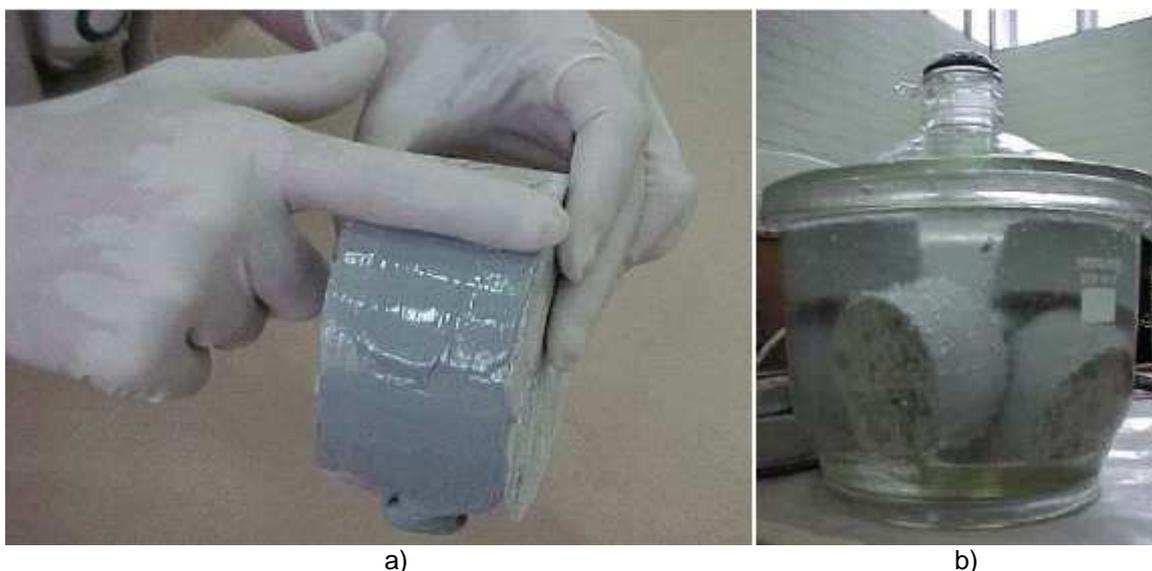
**Figura 2.** Ensaio de migração íons cloreto: a) selagem da superfície lateral do corpo-de-prova com silicone e b) saturação com água destilada dos corpos-de-prova
