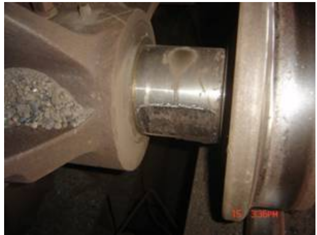
Fonte: ArcelorMittal Tubarão. Figura 9. Desgaste do eixo.
