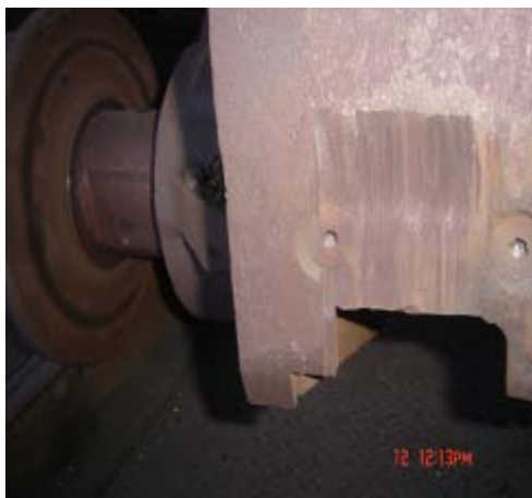
Fonte: ArcelorMittal Tubarão. Figura 10. Desgaste chapa cabeçote.
