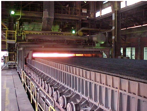
Fonte: ArcelorMittal Tubarão. Figura 1. Máquina de Sinter.
