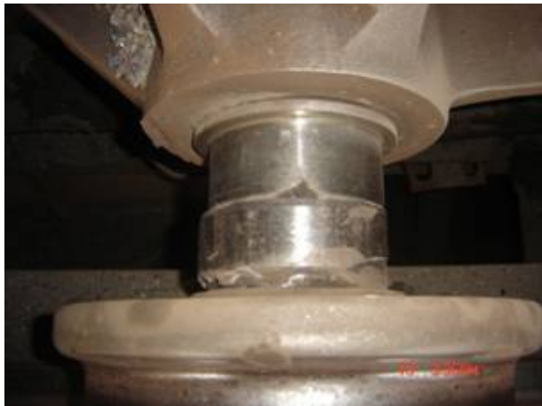
Fonte: ArcelorMittal Tubarão. Figura 8. Quebra da pista externa.
