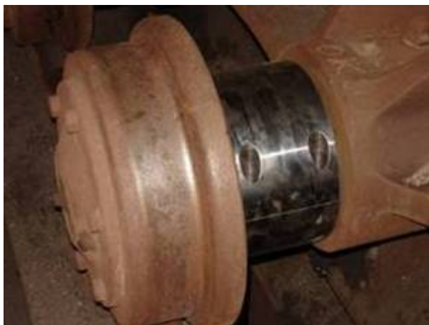
Figura 16. Bucha bipartida para substituição provisória dos rolamentos de pressão.
