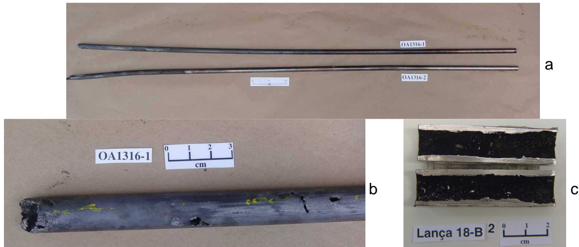
Figura 5. Lanças empenadas e detalhes da degradação de uma delas.
