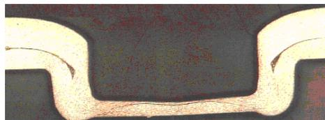
**Figura 12.** Micrografia da união por Ponto Tox®, aumento (50X).
