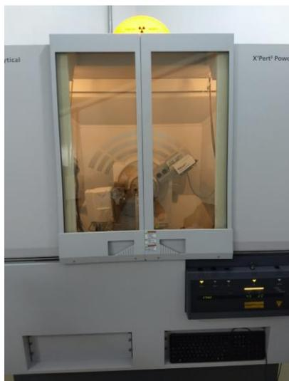
**Figura 4.** Difratorômetro de raios-X do modelo X'Pert Pro 3 MPD (PW 3040/60) PANalytical
