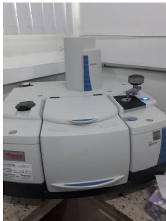
**Figura 6.** Espectrômetro de infravermelho com transformada de Fourier da marca Thermo Scientific, modelo Nicolet iS50 FTIR
