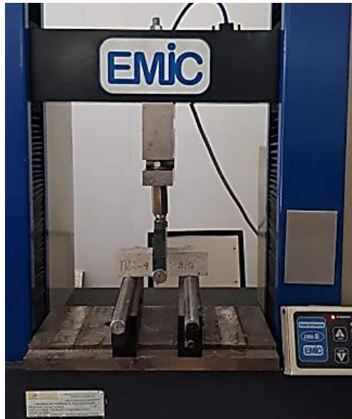
Figura 2. Ensaio para a determinação da resistência à tração na flexão da argamassa de assentamento.
