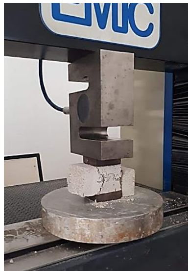
Figura 3. Ensaio para a determinação da resistência à compressão da argamassa de assentamento.
