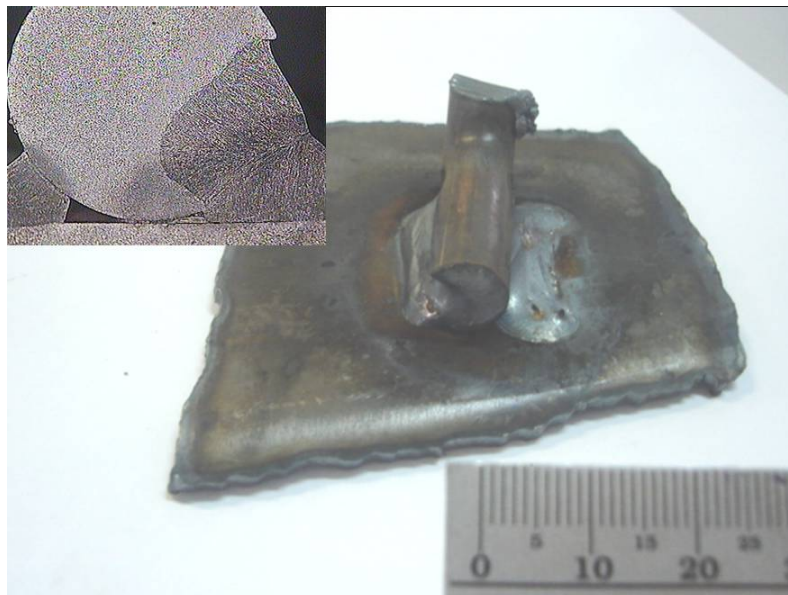
Figura 6 – Solda Deslocada do gancho do quadro auxiliar
