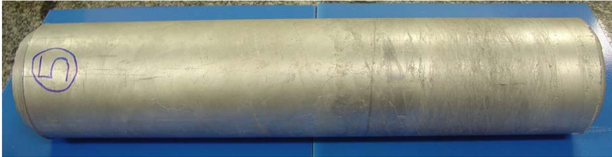
**Figura 2.** Tubo centrifugado da corrida 5.
