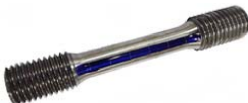
Figura 1. Corpo-de-prova utilizado nos ensaios de tração a 600°C.
