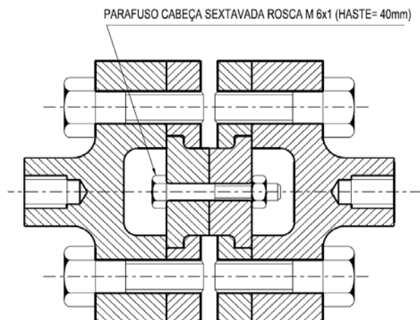
Figura 2. Dispositivo produzido para os ensaios de fadiga dos parafusos M6.
