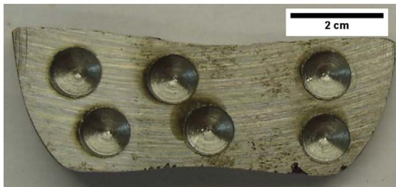
Figura 2 - Seção transversal de aço remanescente do cadinho mostrando pontos de análise química.
