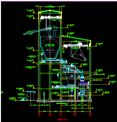
Figura 4. Arranjo mecânico do prédio da britagem secundária convencional.
