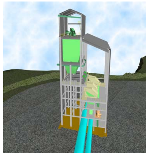
Figura 4. Arranjo mecânico do prédio da britagem secundária convencional.
