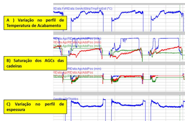
Figura 8. Efeito da variação da Temperatura de Acabamento sobre o perfil de espessura
