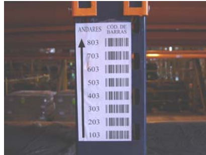
Figura 21. Identificação de uma coluna de estocagem do porta-pallet
