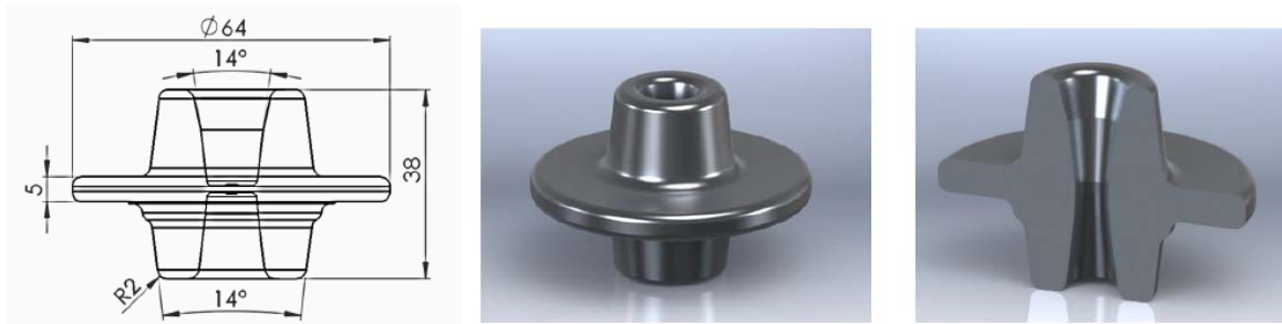
Figura 7. Exemplo de flange projetado conforme padrões dimensionais apresentados [9].
