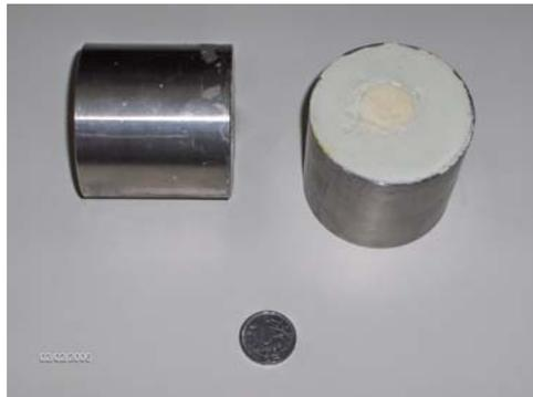
**Figura 3.** Foto do anel metálico e do molde cerâmico, antes da deceragem.
