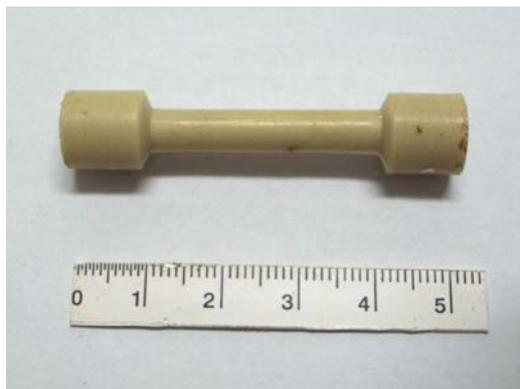
**Figura 1.** Foto do modelo de cera do corpo de prova de tração empregado no trabalho.
