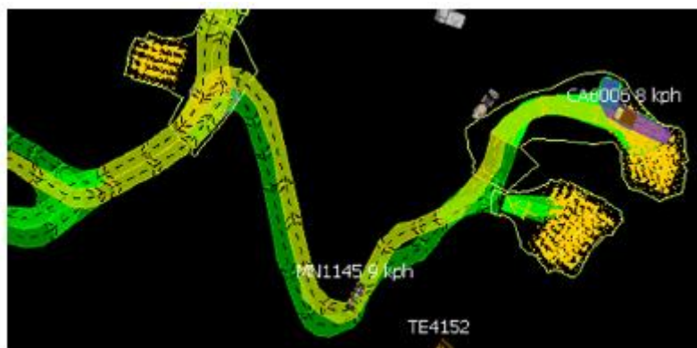
Figura 3. Virtualização da mina; acessos e praças de carga e basculamento são mapeados no ambiente físico e representados no sistema de operação autônomo.
