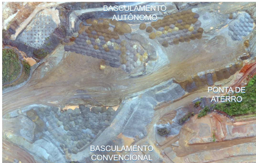
Figura 6. Comparação entre contrapilhamento realizado por frota autônoma, acima, e convencional, abaixo.
