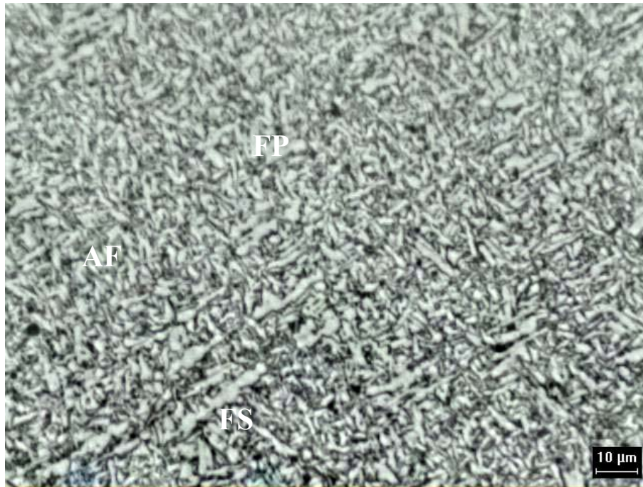
Figura 11 – Microscopia óptica do cordão de solda na condição “Como Soldado” Ataque Nital 2%, 500X
