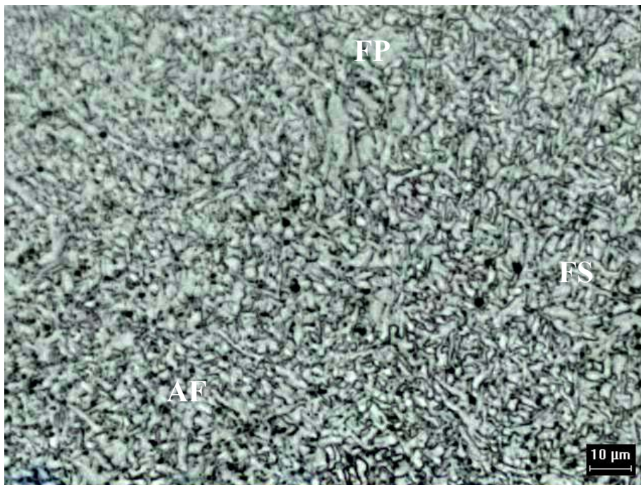
Figura 12 – Microscopia óptica do cordão de solda na condição “Como Tratado” Ataque Nital 2%, 500X
