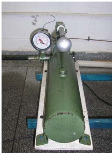
Figura 2. Câmara de pressão acoplada na estrutura da máquina de trefilar.
