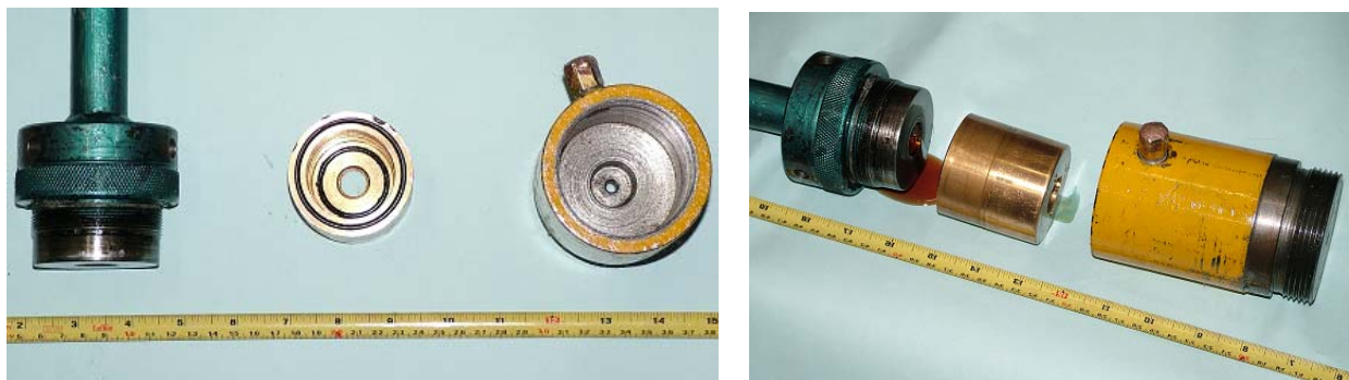
Figura 4. Dispositivo adaptado à máquina de trefilar para aplicação da pressão hidrostática interna para diminuir o coeficiente de atrito (pedido de patente depositado).
