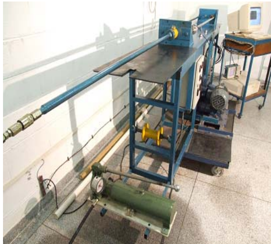
Figura 2. Câmara de pressão acoplada na estrutura da máquina de trefilar.
