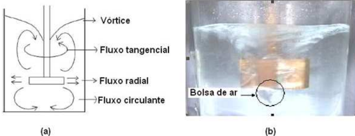
Figura 3 – a) Tipos de fluxos durante a agitação mecânica do banho metálico; b) Formação de bolsão de ar sob a base do agitador mecânico. (4)
