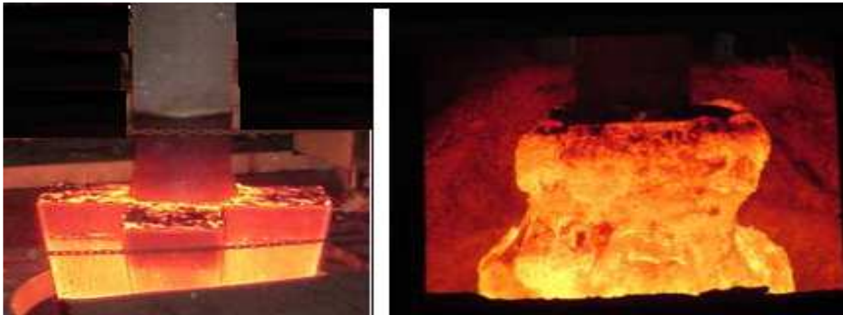
Figura 4 – Perfil do agitador mecânico: a) Agitador mecânico novo; b) Acreções na parte superior do agitador mecânico.
