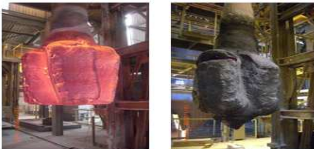
Figura 9 – Perfis de desgaste: a) Agitador do KR, após 16 corridas; operação descentralizada; b) Agitador do KR, após 5 corridas, posição central.
