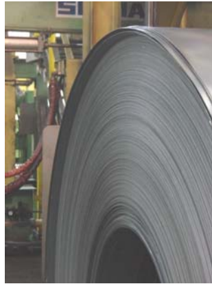
Figura 11. BQ com ocorrência de TE externa; tira que tende a apresentar RX no LA
