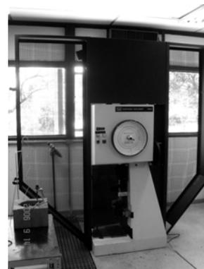
**Figura 3** - Máquina pendular de impacto Charpy, 300 J (Laboratório B).
