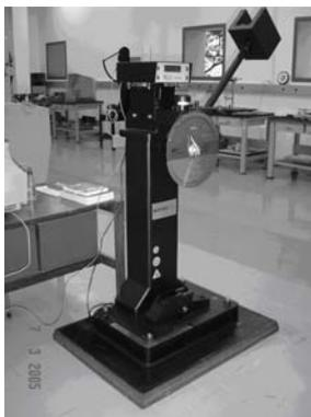
**Figura 2** - Máquina pendular de impacto Charpy, DI-300, 406,7 J (Laboratório A).
