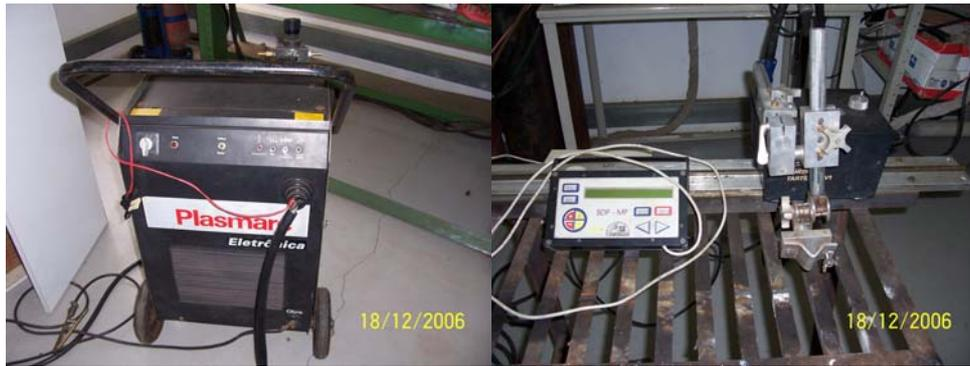
**Figura 2.** Fonte de corte a plasma e sistema de avanço automático.
