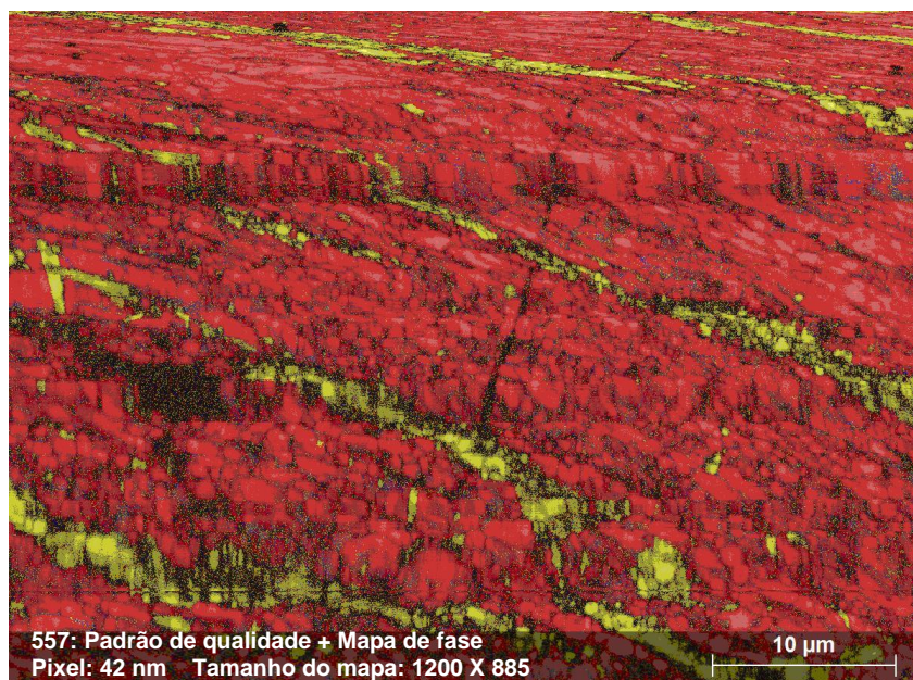
Figura 3. Mapa de distribuição de fases: amostra submetida a 1 passe EAC à temperatura de 375°C: predominância do titânio (cor vermelha) com partículas de hidretos de titânio nas interfaces geradas pelas partículas de titânio que foram compactadas e posteriormente extrudadas (cor amarela).
