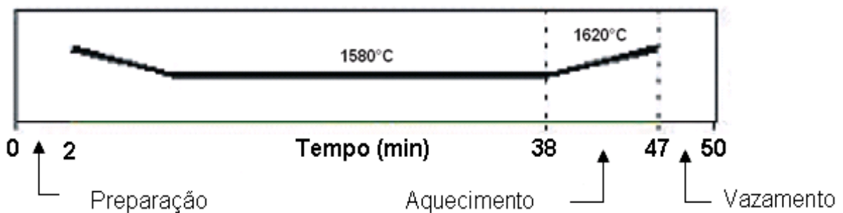
Figura 6. Esquema do perfil de temperatura durante as fases do processo.
