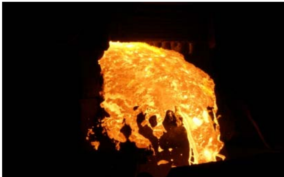
Figura 5. Ilustração da espumação da escória.
