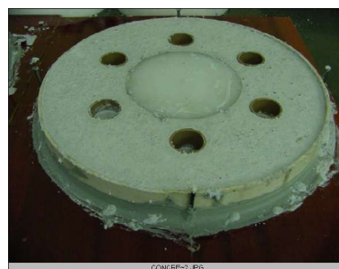
Figura 4 – Peça em concreto refratário em processo de cura ao ar.
