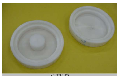
Figura 1-Moldes em polímero para a concretagem da parte cerâmicas.
