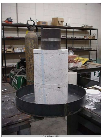
Figura 5 - Montagem das peças cerâmicas dentro da carcaça metálica.
