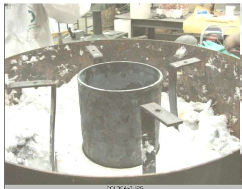
Figura 6 – Preenchimento com manta cerâmica.
