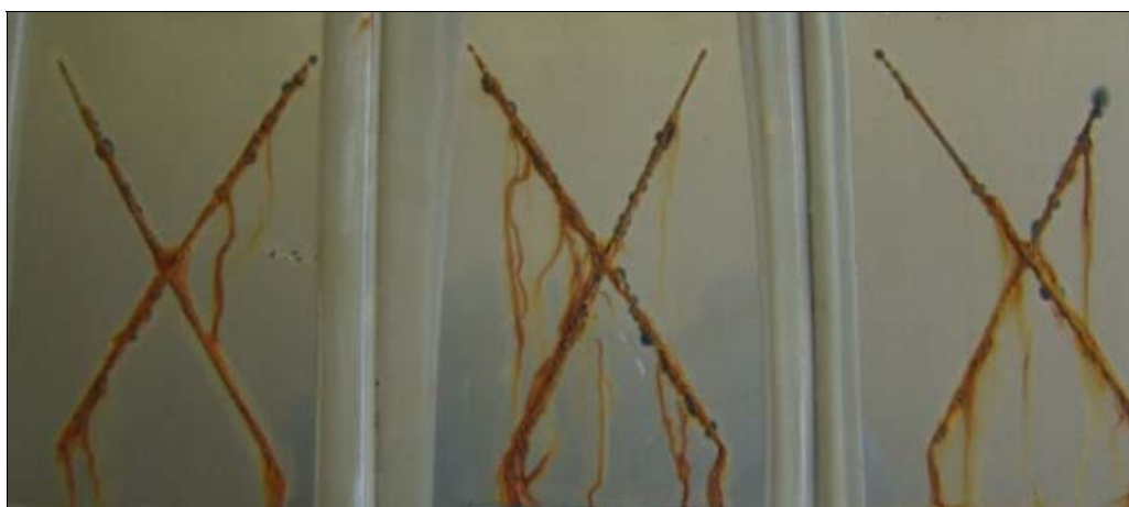
Figura 4. Aspecto das amostras TE/0-SMMT após 240 horas de exposição à névoa salina.
