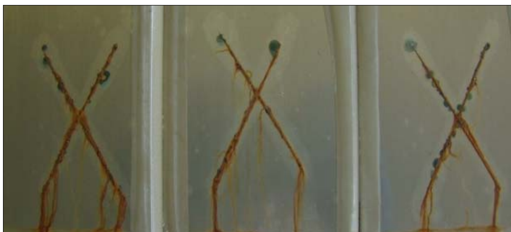
Figura 5. Aspecto das amostras TE/8-SMMT após 240 horas de exposição à névoa salina.
