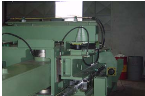
Figura 16. Vista do colchão de ar do Carro Rebarbador.
