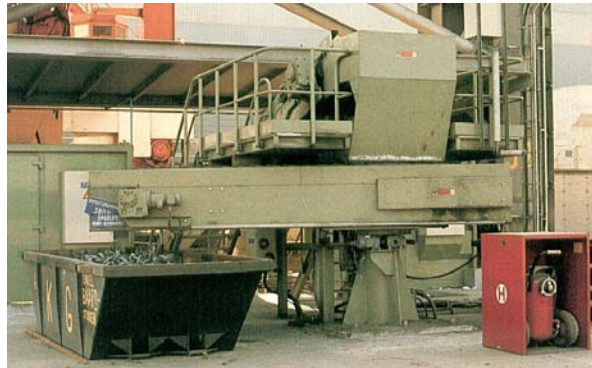
Figura 8: Vista de um sistema de remoção de rebarbas.
