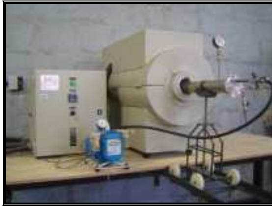
Figura 2. Forno resistivo tubular de marca JUNG J200.
