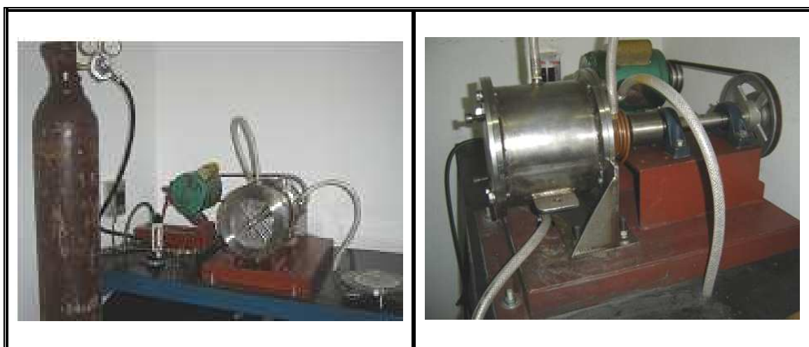
Figura 1. Moinho de alta energia do tipo atritor horizontal.
