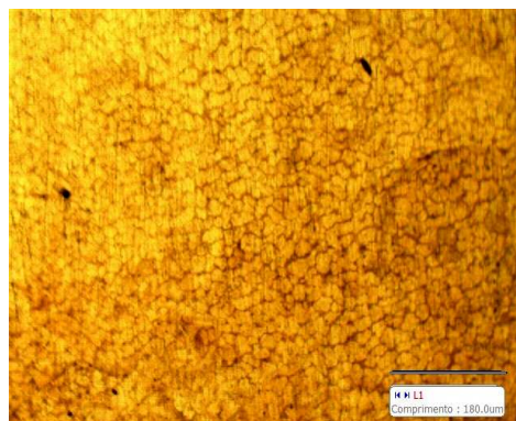
Figura 1 – Aspecto micrográfico da amostra 01 de Cobre ETP com deformação de 30% Recozida por 1h a 400°C e temperada, mostrando o andamento do processo de recristalização. Ampliação: 100 vezes
