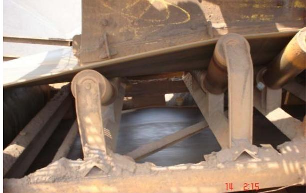
**Figura 2:** a) Problema de derramamento de material num ponto de transferência. b) Um chute de carga montado na zona de transição da correia, causando vazamento de material.
