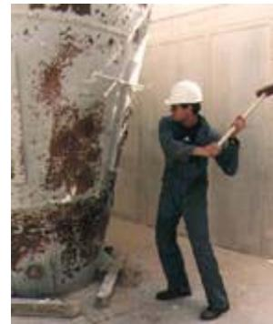
**Figura 3.** a) Tarefas de limpeza da área serão sempre necessárias para o controle de material fugitivo, mas em pontos de transferência mal projetados as condições de operação e a produtividade resultam ainda mais prejudicadas. b) Problemas de entupimento devem ser evitados desde a etapa de projeto, e não com “intervenções” pouco convenientes durante a operação.
