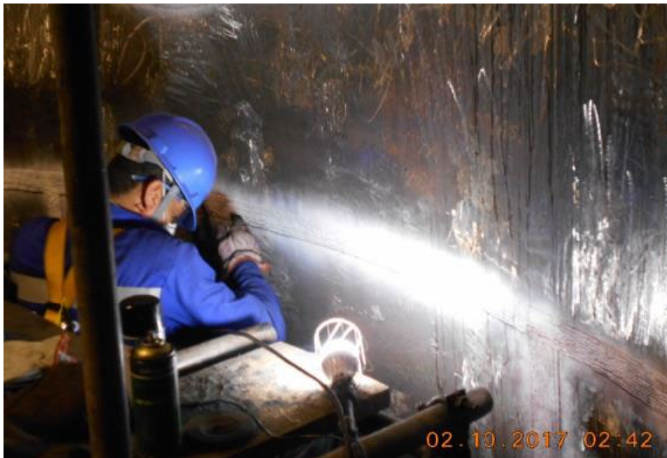
Figure 10 – Inspeção LP sendo executada em solda da carcaça.
