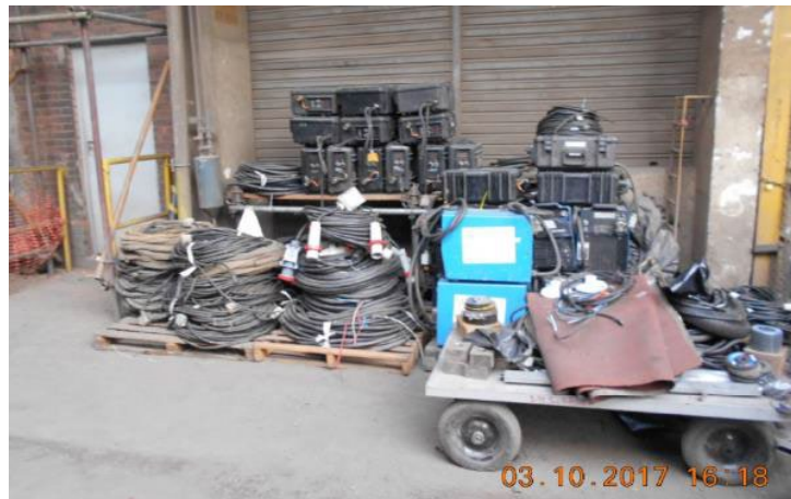
Figure 5 – Cabeçotes e cabos das máquinas de solda durante preparação.
