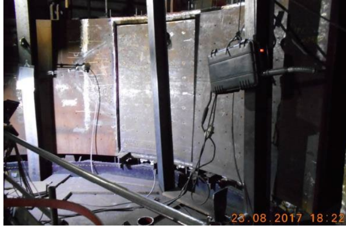
Figure 7 – Chapas novas posicionadas no anel de suspensão.
