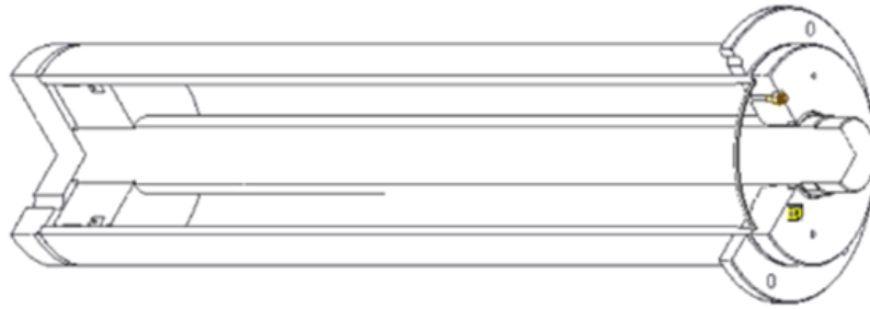
Figura 3. Modelo 3D do cilindro hidráulico projetado.
