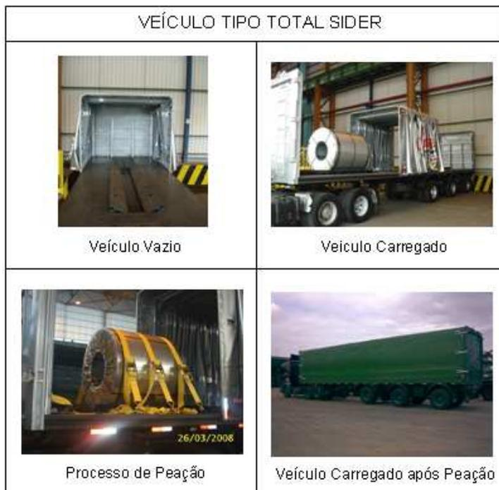
Figura 3 – Veículo bobineiro total sider.
