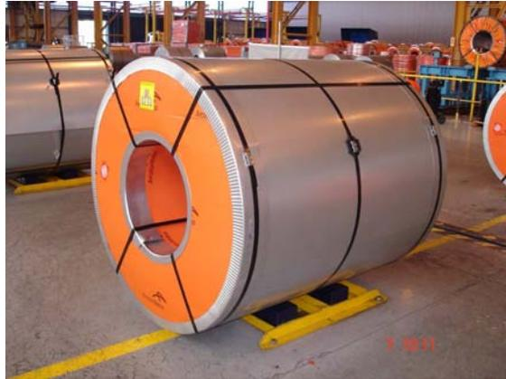
Figura 1 – Embalagem com capa interna e disco em plástico corrugado e cantoneira e capa externa em aço.
