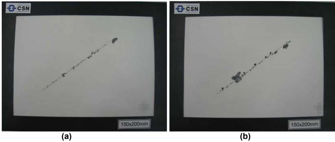
**Figura 4.** Foto das amostras após ensaio de 500 hs no Salt Spray.(a) Material zincado com cromo (b) Material zincado sem cromo .
